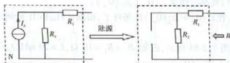
图 7.2-53 去掉电感后二端网络 N 二端网络 N 的无源网络
